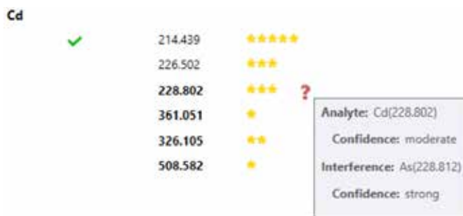
Рис. 2. IntelliQuant отмечает наиболее оптимальную длину волны аналита наибольшим количеством звезд и зеленой «галочкой». Подозрительные помехи на длине волны аналита отмечены малым количеством звезд. Потенциальные наложения спектров можно определить путем наведения курсора на красный знак вопроса.
